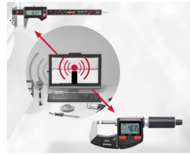
Figura 2 - Equipamentos metrológicos com ligação sem fios a dispositivos de processamento de dados
