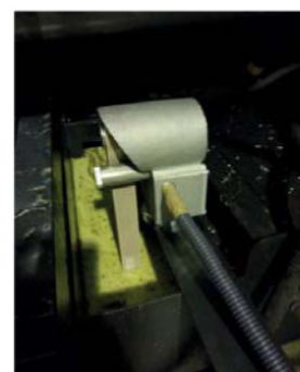
Figura 3. Skimmer em funcionamento no tanque de armazenamento das emulsões no centro de maquinação CNC – Núcleo de Amarante do CENFIM.
